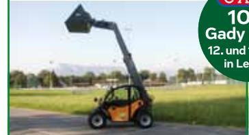
4.800 mm Hubhöhe, 45 PS Kubota Motor, Hydrostatischer Allradantrieb, II Fahrstufen 25 kmh
