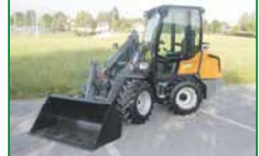
von 20 – 60 Ps, starke Bauweise, höchste Hubkraft, Kubota Motore, Rexroth Hydrostat
